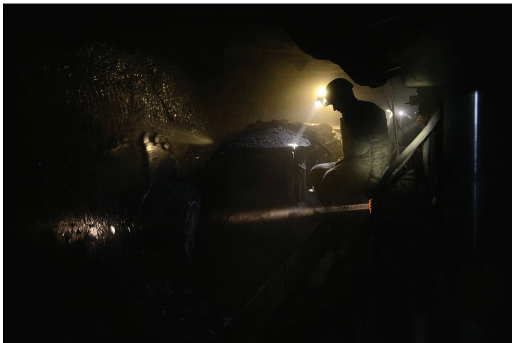
Rudnik "Haljići" posluje u sklopu Rudnika mrkog uglja "Kakanj". Rudari u ovoj jami nadziru rad mašine za otkopavanje uglja u mehanizovanom „širokom čelu“. (Foto: CIN)
